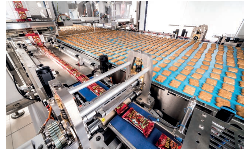
Die fliegende Quersiegeleinheit fährt beim Heißsiegeln so an der Kette mit, dass die Siegelzeit immer konstant bleibt. The flying cross-sealing unit moves along the chain during heat sealing so that the sealing time always remains constant.
