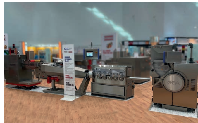
Hochgeschwindigkeitsformanlage für gefüllte Lollis von Proform, Hänsel Processing und GEA Aquarius. (Bild: Hänsel Processing/Proform/GEA Aquarius) High speed forming line for filled lollipops from Proform, Hänsel Processing and GEA Aquarius. (Image: Hänsel Processing/Proform/GEA Aquarius)
