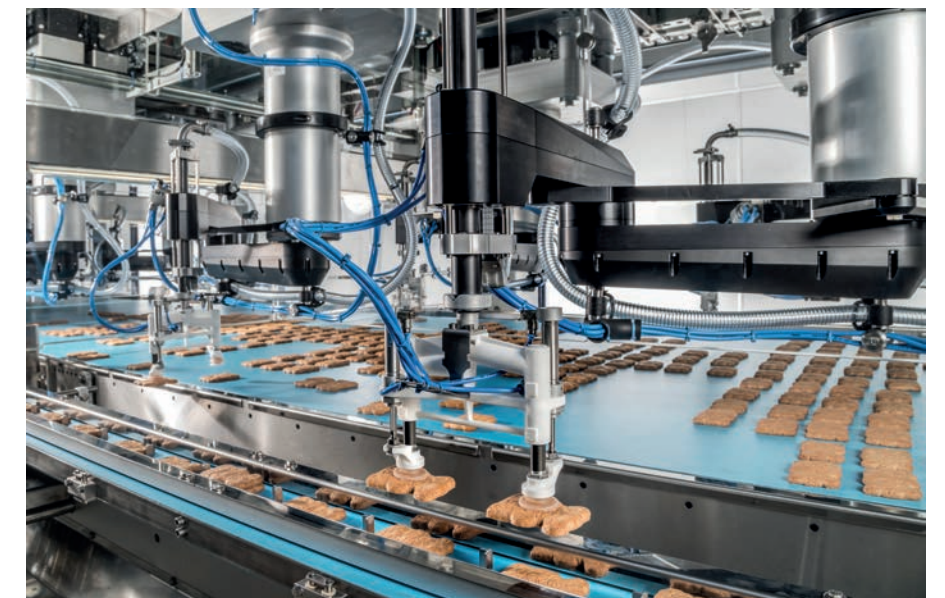
Das redundante Maschinenkonzept basiert auf dem Schubert-Flowpacker, der die Zuführung per Pick-and-Place und das Verpacken im Flowmodul nahtlos in einer Linie integriert. The redundant machine concept is based on the Schubert Flowpacker, which seamlessly integrates feeding via pick & place and packaging in the Flowmodul into a single line.
