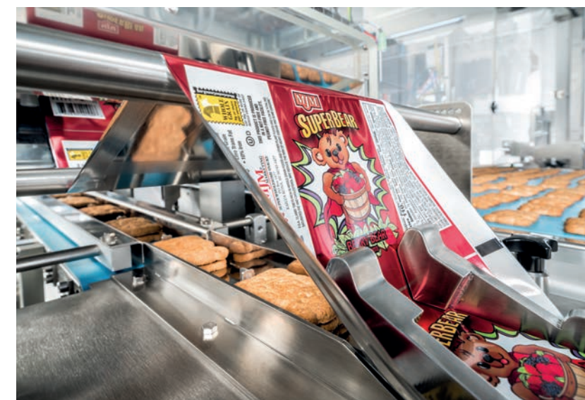
Dank der flexiblen Siegeltechnologie von Schubert kann der Kunde ohne großen Aufwand von Kaltsiegelung auf Heißsiegelung umsteigen. Thanks to Schubert's flexible sealing technology, the customer can switch from cold sealing to heat sealing with very little effort.
