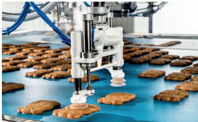
26 F4-Roboter nehmen die fertigen Kekse schonend per Doppelpick auf und legen sie in die Ketten der vier Flowmodule. 26 F4 robots carefully pick up the finished biscuits by double pick – and then place them into the chains of the four Flowmodules.
