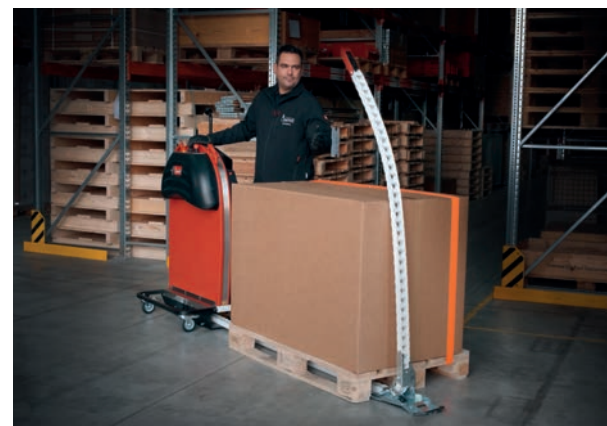
Anwendung der ErgoPack RE. Die Kettenlanze bringt das wiederverwendbare Klettband um die Palette herum und zurück zum Anwender. (Bilder: ErgoPack) Application of the ErgoPack RE. The chain lance brings the reusable hook and loop tape around the pallet and back to the user. (Images: ErgoPack)
