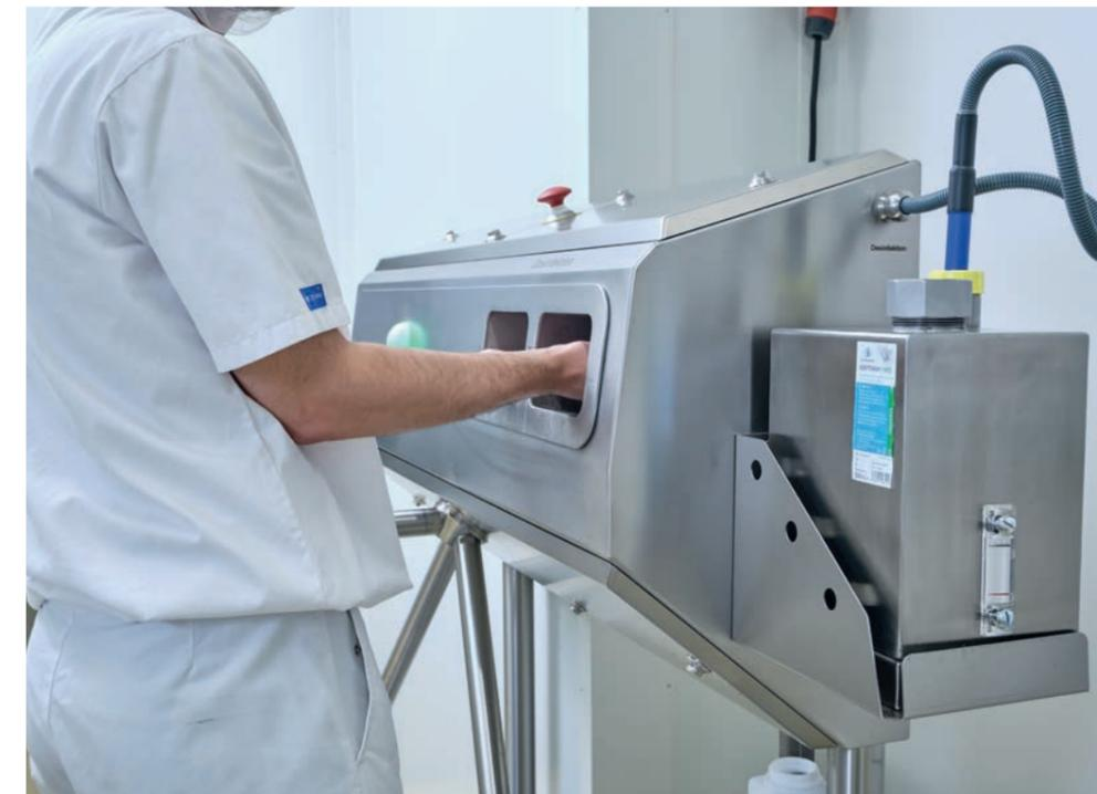
Überlistungssichere Zwei-Hand-Desinfektion vor Zutritt in die Produktion.
