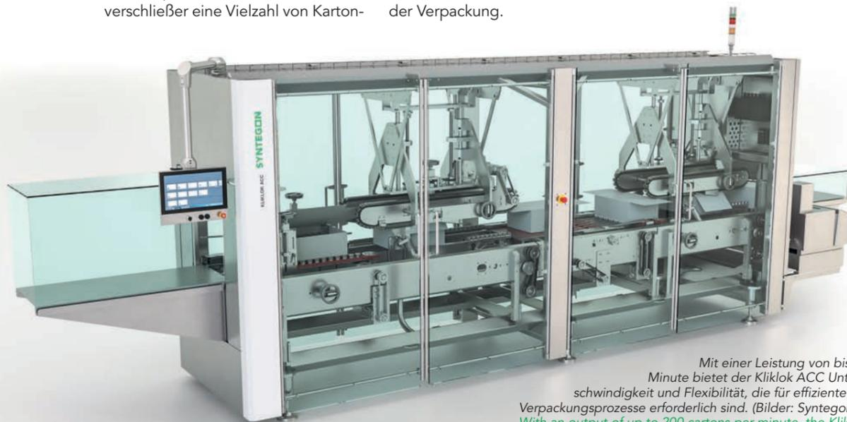
Mit einer Leistung von bis zu 200 Kartons pro Minute bietet der Kliklok ACC Unternehmen die Geschwindigkeit und Flexibilität, die für effiziente und zuverlässige Verpackungsprozesse erforderlich sind. (Bilder: Syntegon)
