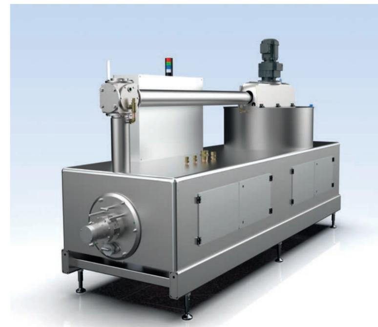
(Re-Work) Temperiermaschine für Massen mit und ohne Beimischungen. Unterschiedliche Typen mit einem Leistungsspektrum von 500 bis 2500 kg/h. (Re-Work) Tempering unit for masses with or without inclusions. Diverse types from 500 up to 2500 kg/h.
