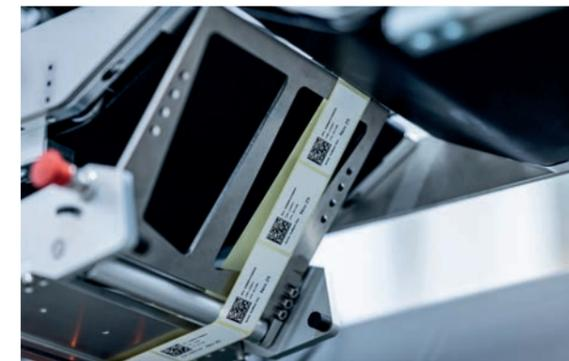
Unterseitenetikettierung und Druck von variablen Daten mit der Etikettieranlage Geset 217.
