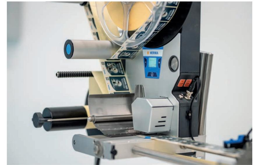
Einfaches Handling, schnelle Ergebnisse: Dafür sorgen die drei großen Bedientasten des Herma eco und die bewährte Menüstruktur mit lediglich einer Bedienebene.
