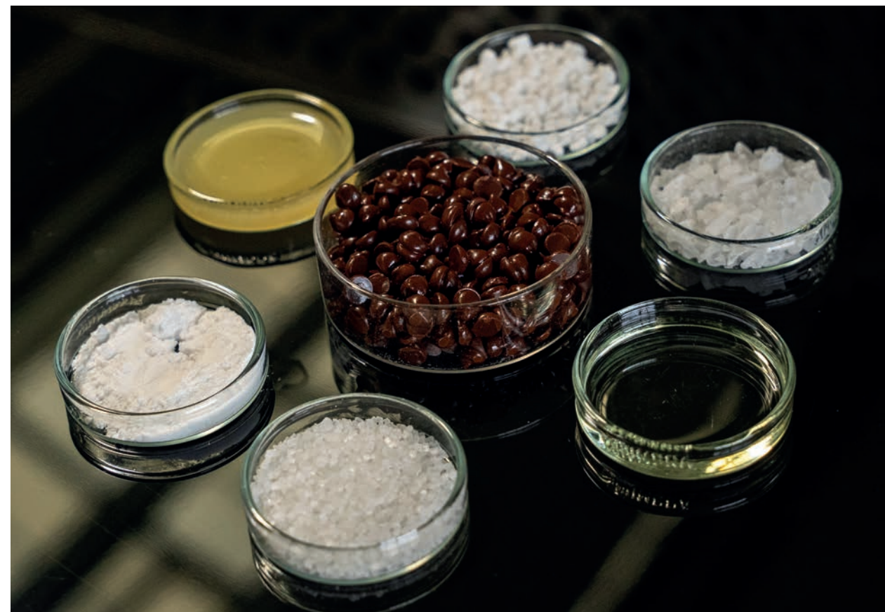
Auswahl an Rohstoffen der Suspensionsmolche für die Schokoladenindustrie (von rechts, im Uhrzeigersinn): Rapsöl, Kristallzucker, Puderzucker, Kakao butter, Hagelzucker und Kandisbruch. (Bilder: Daniel Csobot) Selection of raw materials for suspension pigs in chocolate industry (from the right, clockwise): rapeseed oil, granulated sugar, icing sugar, cocoa butter, pearl sugar and rock candy. (Images: Daniel Csobot).
