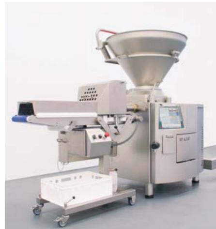
In Kombination mit einem Teigteiler des Typs VF 600 B teilt das SE 442 Teige unterschiedlicher Art.
