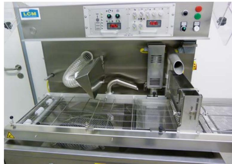
Die Überzugsmaschine LCM ATC-P 320 mit Zwischenpumpe.
