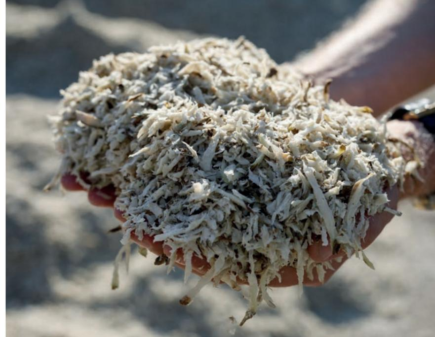
Die Zuckerrübe wird nach dem Waschen zu Zuckerübenschneitzeln zerkleinert. Mithilfe von Wasser wird anschließend der Zucker aus der Rübe extrahiert. After washing, the sugar beet is crushed into sugar beet pulp. Water is then used to extract the sugar from the beet.
