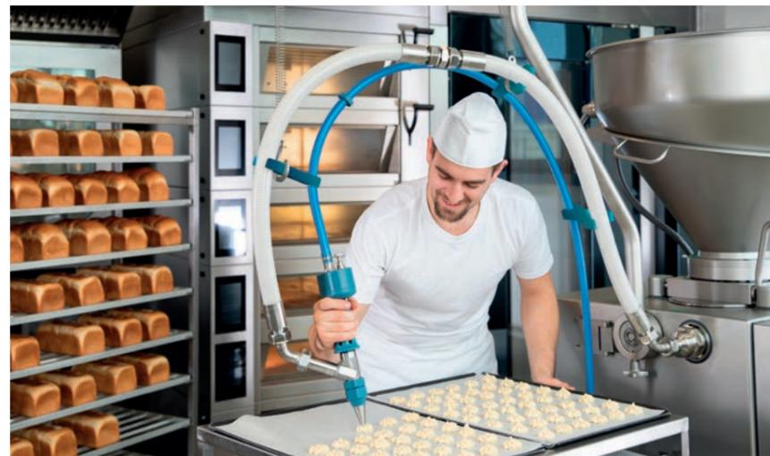
Dosierventil DV 85-1 zum Dosieren pastöser und flüssiger Produktmassen (Bild: Handtmann)
