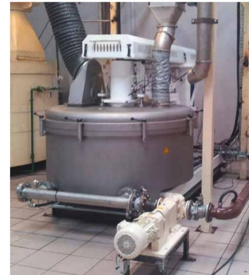
Dank der speziellen Konstruktion von MasterNibs-Schlagmessermühlen lassen sich die Schlagleisten schnell austauschen.
