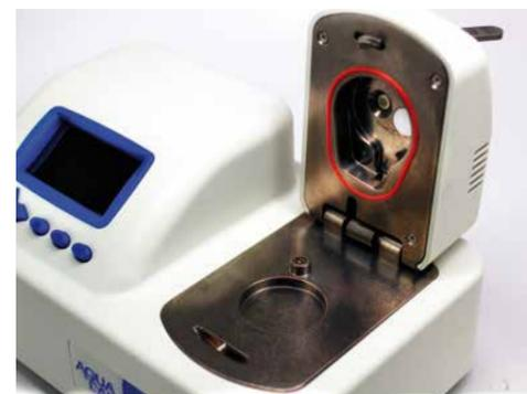
Das System AquaLab Serie 4TE bietet einen Messbereich von 0,030 bis 1,000 aw. AquaLab Serie 4TE with a measurement range of 0.030 to 1.000 aw.
