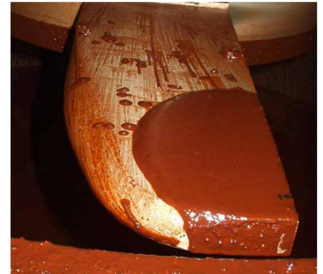
Verschleiß an der Vorderkante (links) eines Schlagmessers in der Schlagmessermühle. Die rechte Kante ist dagegen noch intakt.
